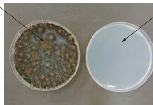
Σύγκριση ανάπτυξης βακτηρίων και μούχλας σε επιφάνειες φτερωτής (εικόνα από μικροσκόπιο)
